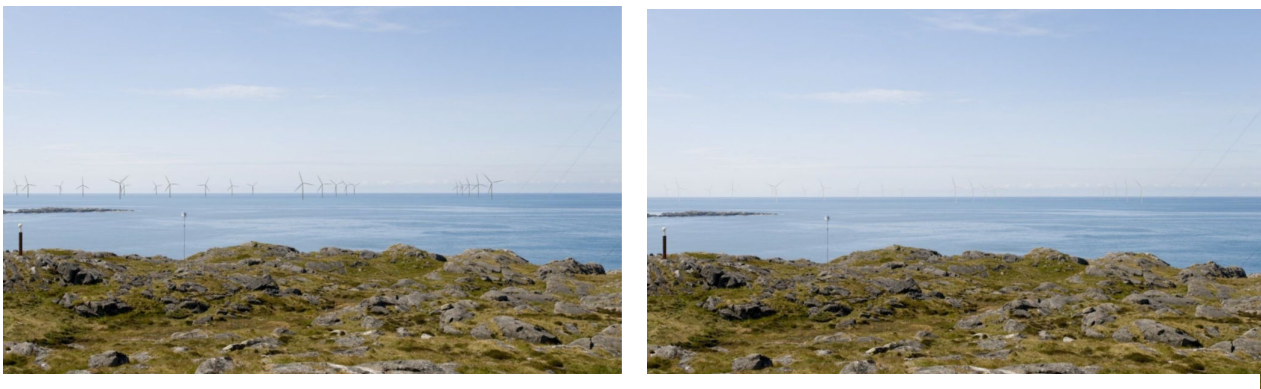
Figur 14 En fotorealistisk visualisering av en havsbaserad vindkraftspark i motljus utan dis (vänster) och med dis (höger) i luften. Visualiseringen har tagit hänsyn till att närmaste vindkraftverk ligger 6 kilometer från land. Den totala höjden är ca 190 meter. Källa: NVE 2023
